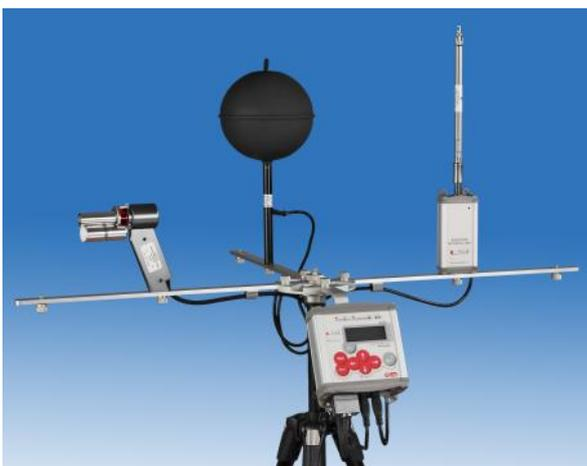
▶ Tipicamente M-Log (ELO009) viene utilizzato su un cavalletto portatile per misure microclimatiche per la valutazione del comfort e stress termico, qualità dell'aria, misure di ventilazione, misure termigrometriche per la valutazione dell'efficienza energetica degli edifici e collaudi termotecnici
