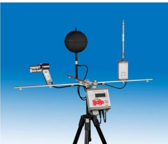
Montaggio M-Log (ELO009) a tripode utilizzando uno stativo.
