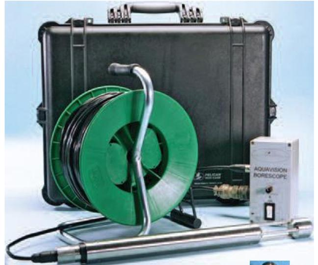
Agua Vision 他是直接準確地量測地下水流速及顆粒的一棟，不需要再輔以水位計、水壓計等額外測量裝置。
