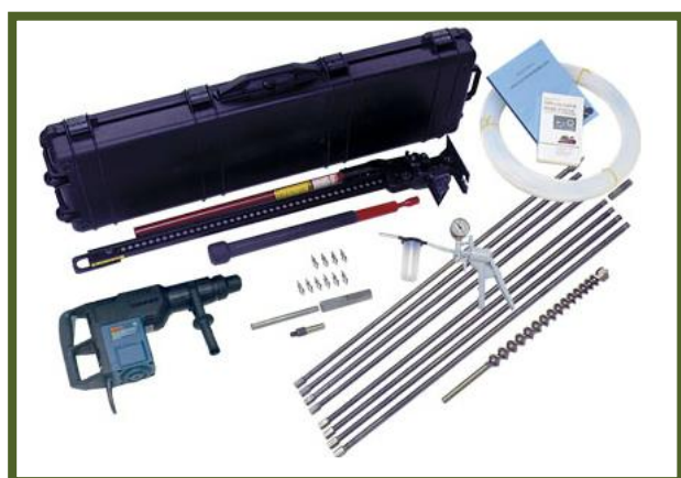
A3：土壤氣體採樣設備 電動採樣機，打擊管、採樣頭與鐵氟龍管 及泵浦
