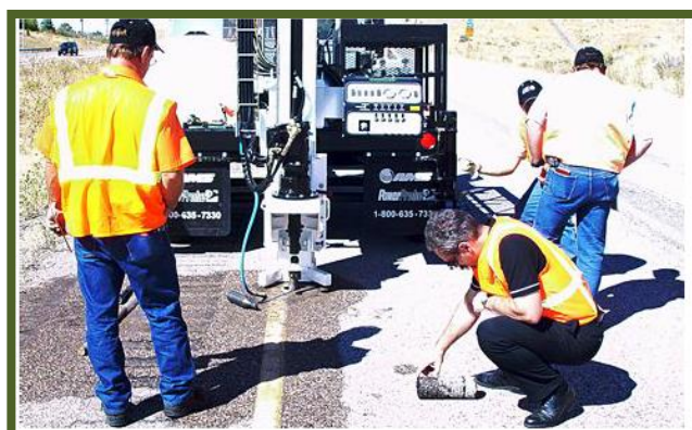
A6：公路鋪面品質採樣車 快速取樣，可檢查施工品質 適用：高速公路/飛機場/一般公路
