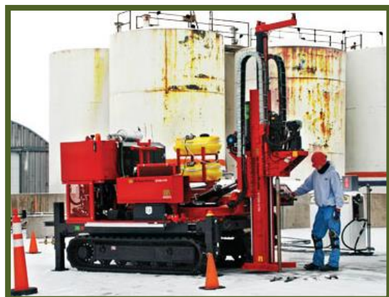
A5：土壤樣品採樣車 輸出大、履帶式設計可以克服嚴峻地形 做現場快速土壤採樣工程
