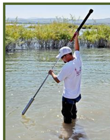
A4：河岸/海砂/底泥各式採樣設備 可依使用者訂製不同敲擊設備
