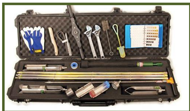
A1：標準式環境土壤採樣組 不銹鋼材質，各式採樣頭、土壤色譜
