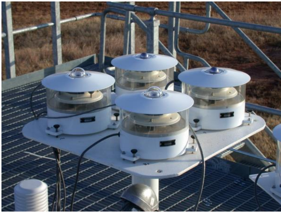
M1：全天空精密日照計 紅外光/ 紫外光 / 淨輻射計
