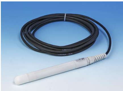
空氣溫度感測棒 DMA033 Type : PT-100 解析度 : 0.01 度 範圍 : -40~80 度 解析度 : 3 分鐘達 90% IP54 防水等級
