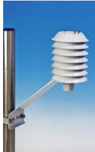
防雨通風罩 DYA230 可安裝溫濕度計 濕度範圍 : 0~100%RH 溫度範圍 : -40~80 度 解析度 : 10 分鐘達 90% 精度 : 1.5%
